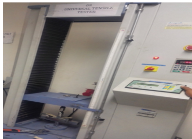
Fig. 7. Universal Tensile Tester Machine
